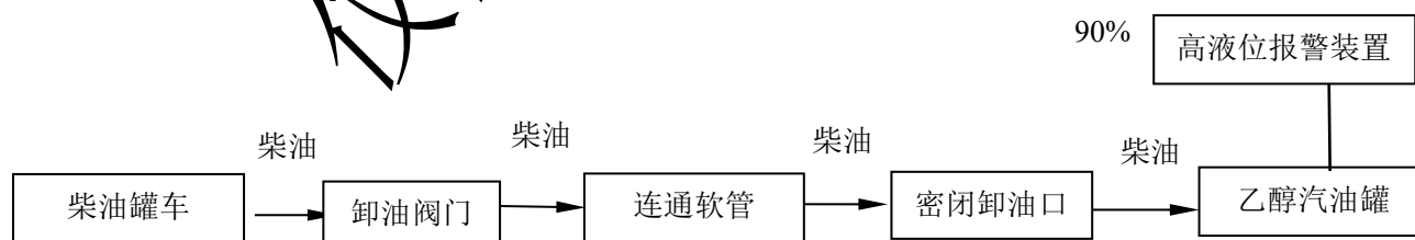
图 2.7-2 柴油罐车卸油工艺流程简图
