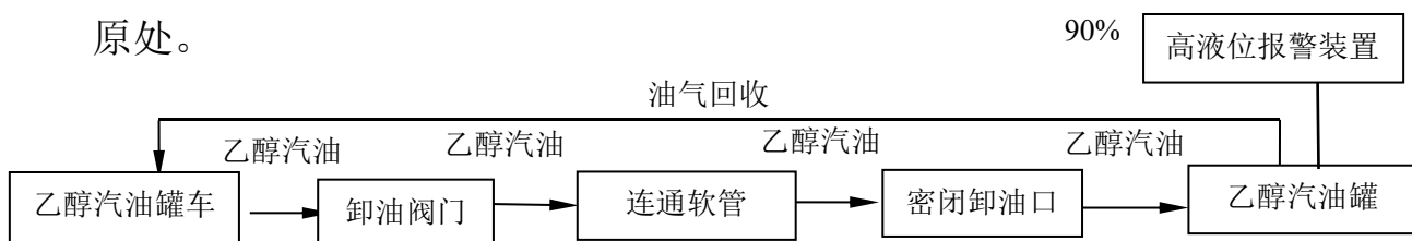
图 2.7-1 乙醇汽油罐车卸油工艺流程简图
