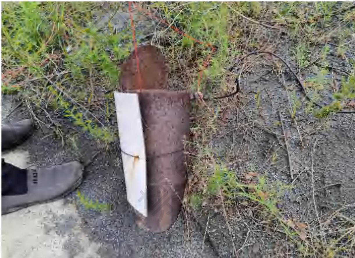
图 2.4-11 人工浸润线观测设施
