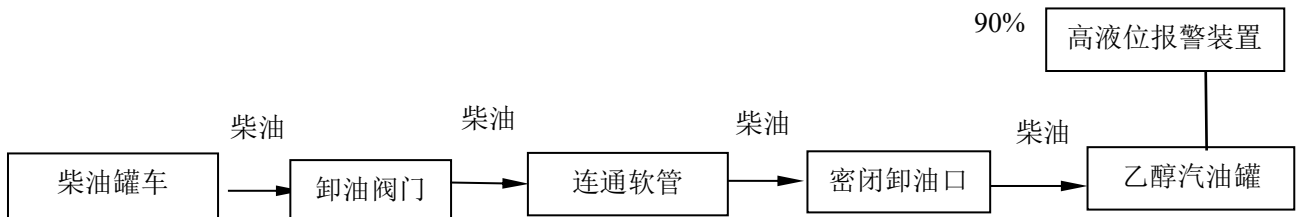
图 2.7-1 柴油罐车卸油工艺流程简图
