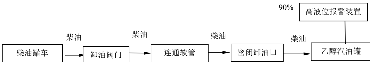
图 2.7-2 柴油罐车卸油工艺流程简图
