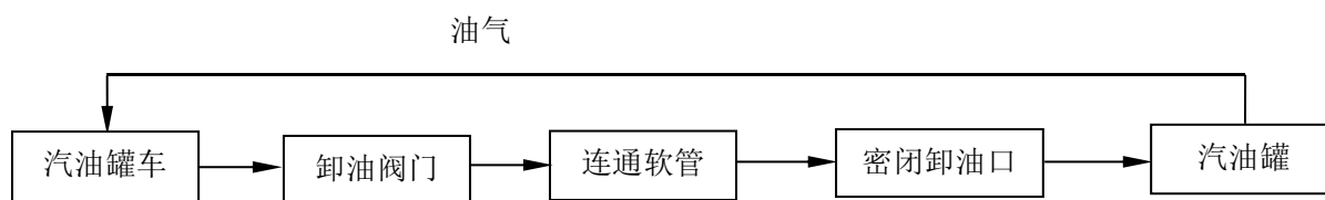
图 2.7-1 乙醇汽油罐车卸油工艺流程简图
