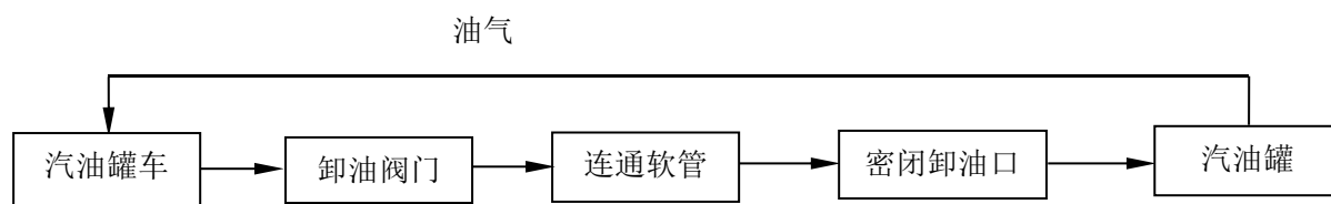
图 2.7-1 乙醇汽油罐车卸油工艺流程简图
