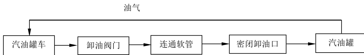
图 2.7-1 乙醇汽油罐车卸油工艺流程简图
