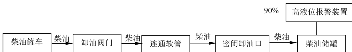
图 2.7-2 柴油罐车卸油工艺流程简图
