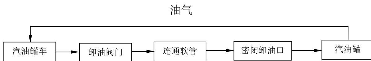
图 2.7-1 乙醇汽油罐车卸油工艺流程简图
