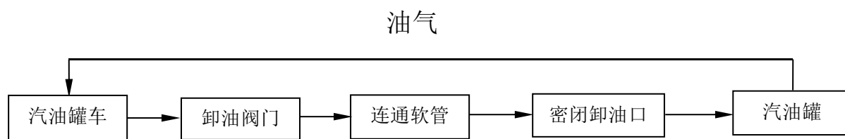
图 2.7-1 乙醇汽油罐车卸油工艺流程简图
