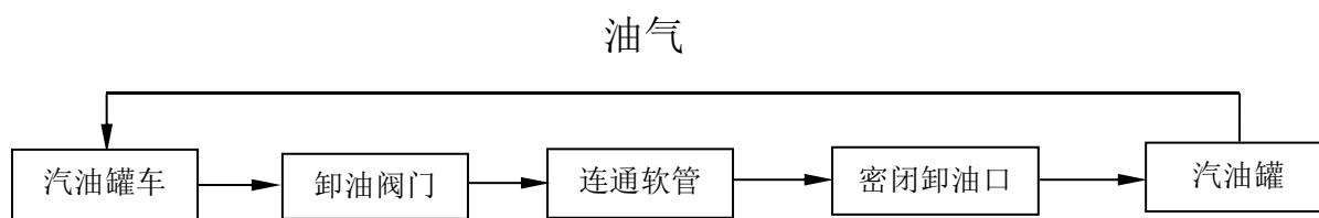
图 2.7-1 乙醇汽油罐车卸油工艺流程简图
