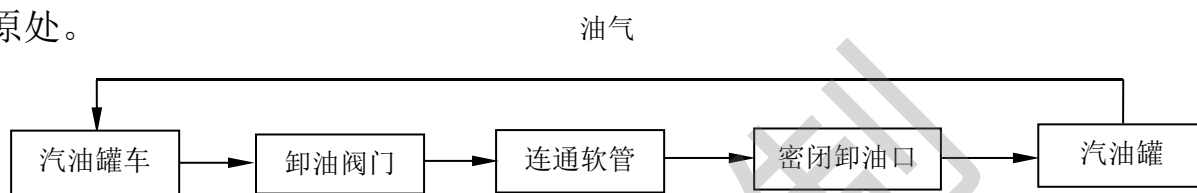
图 2.7-1 乙醇汽油罐车卸油工艺流程简图
