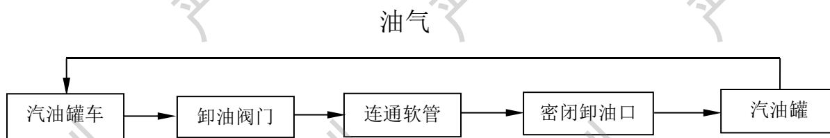
图 2.7-1 乙醇汽油罐车卸油工艺流程简图
