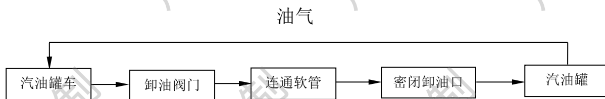
图 2.7-1 乙醇汽油罐车卸油工艺流程简图
