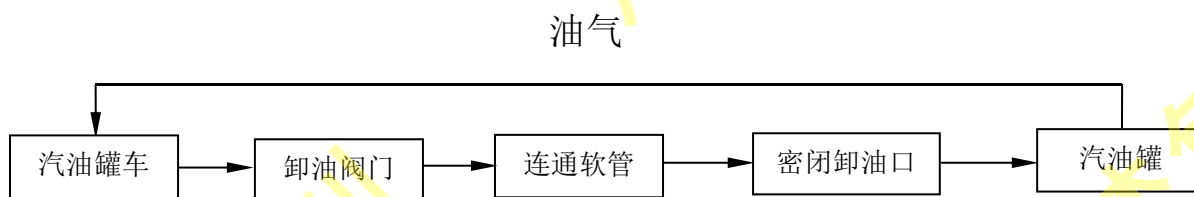
图 2.7-1 乙醇汽油罐车卸油工艺流程简图
