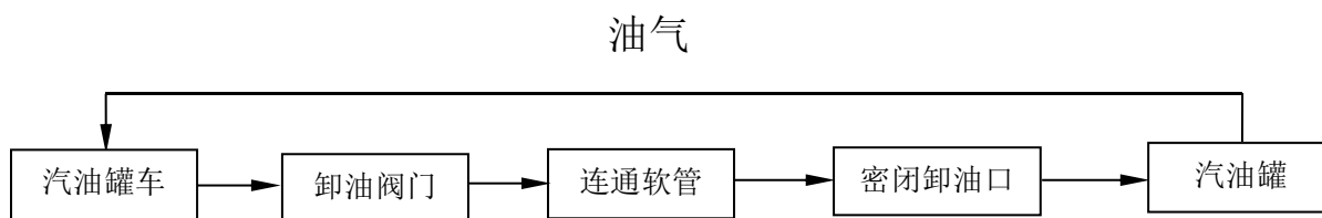
图 2.7-1 乙醇汽油罐车卸油工艺流程简图
