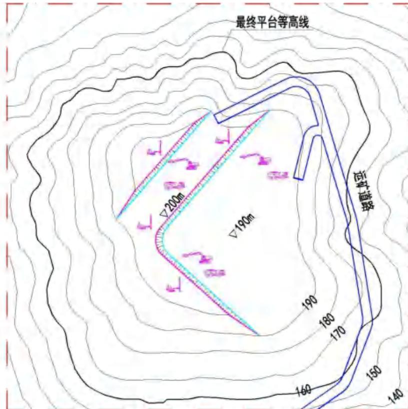
图 8.1-2 孤山型山坡露天矿山开采平面示意图
