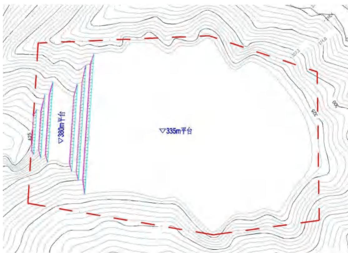
图 8.3-2 山脊型山坡露天矿山开采平面示意图
