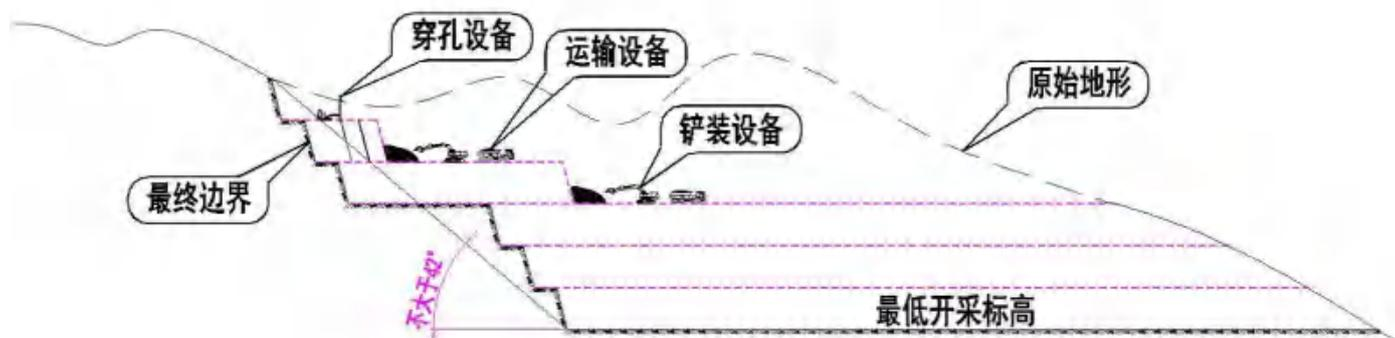
图 8.3-1 山脊型山坡露天矿山开采剖面示意图
