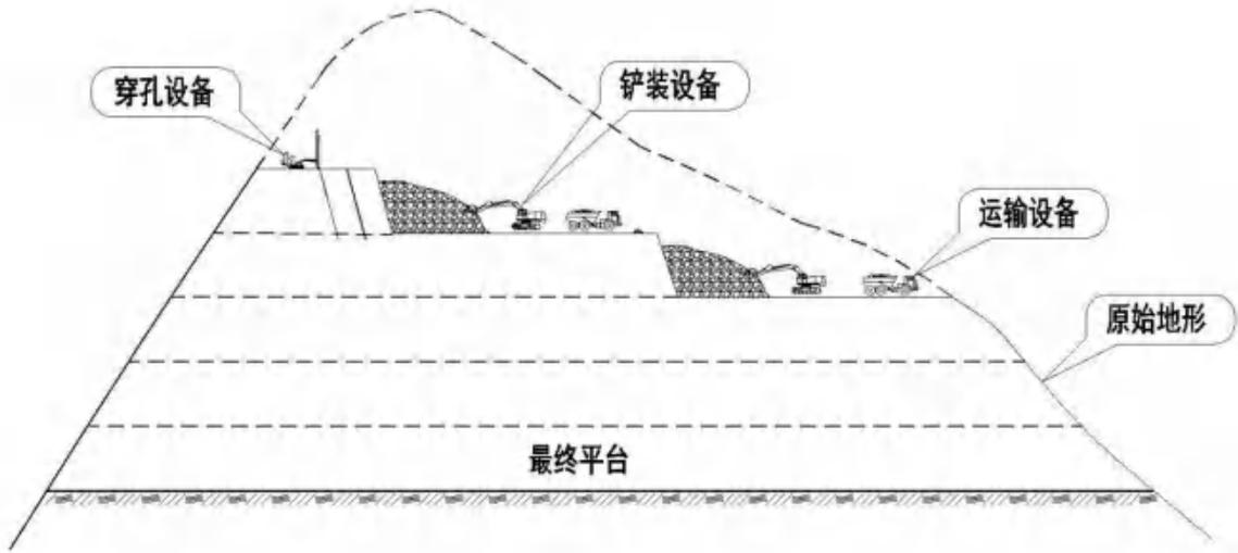
图 8.1-1 孤山型山坡露天矿山开采剖面示意图
