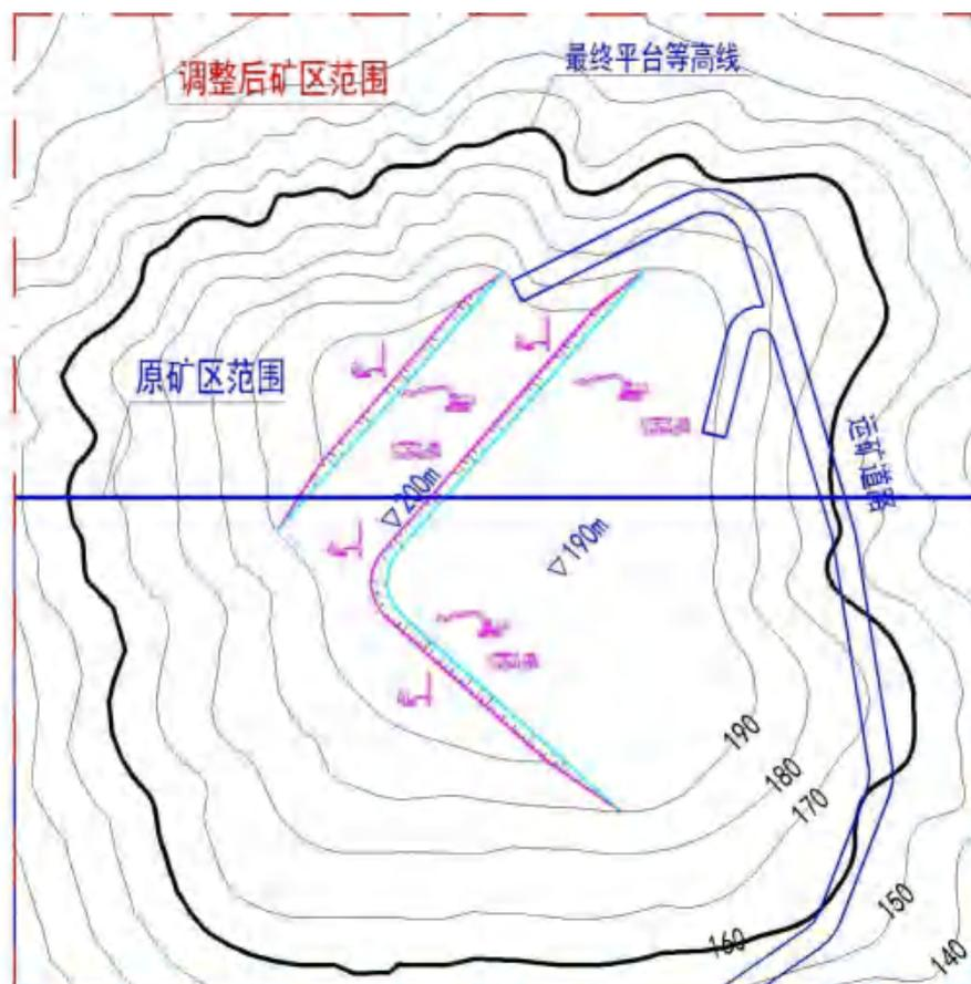
图 8.2-2 半山型山坡露天矿山开采平面示意图
