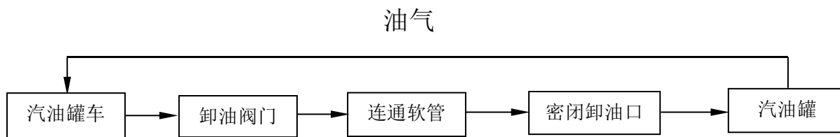
图 2.7-1 乙醇汽油罐车卸油工艺流程简图
